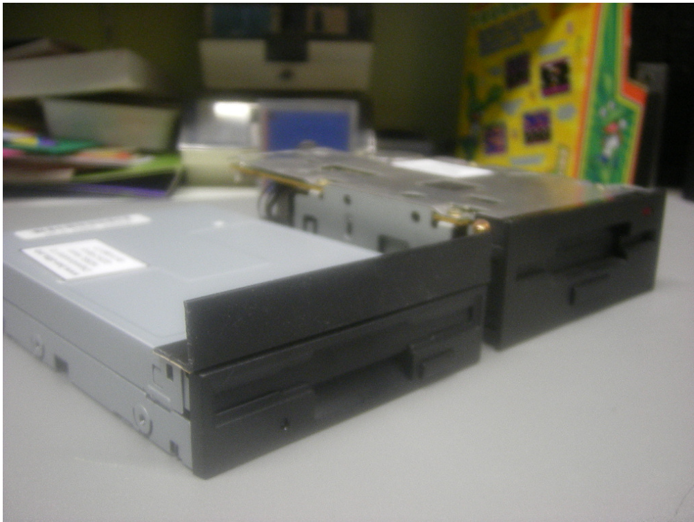
Links: dubbelzijdige diskdrive met hoeklijn Rechts: originele enkelzijdige diskdrive
