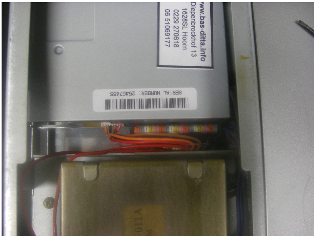
De kabels zijn aangesloten op de nieuwe dubbelzijdige diskdrive
