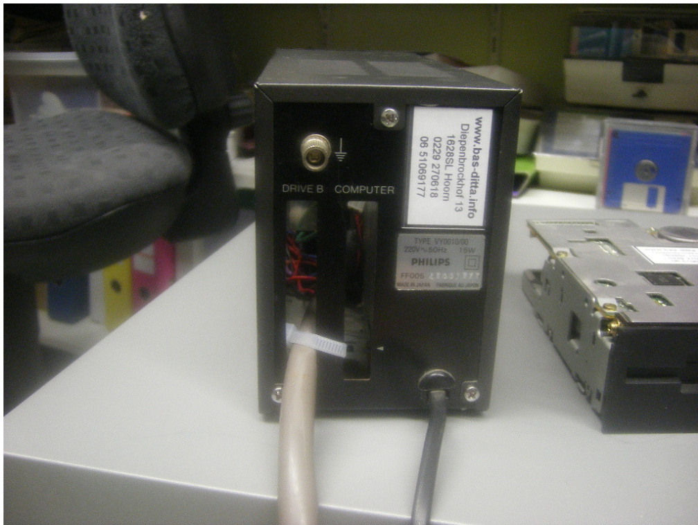
Tyrap gebruikt als trekcontlasting
