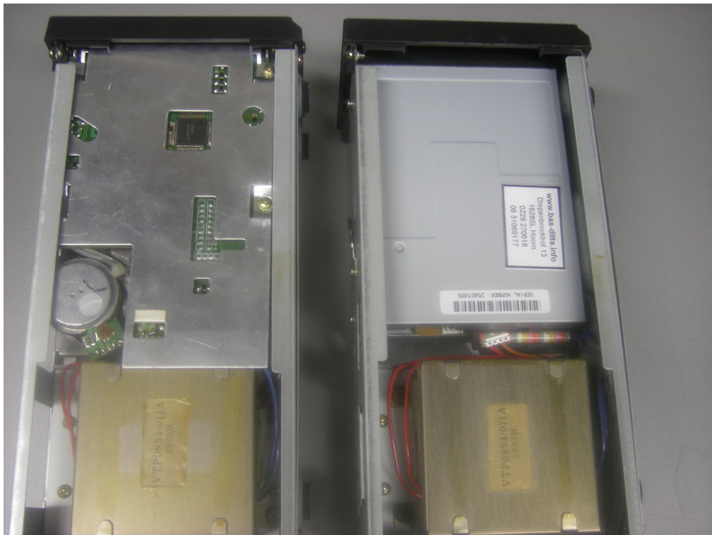
Links: originele enkelzijdige diskdrive Rechts: nieuwe dubbelzijdige diskdrive
